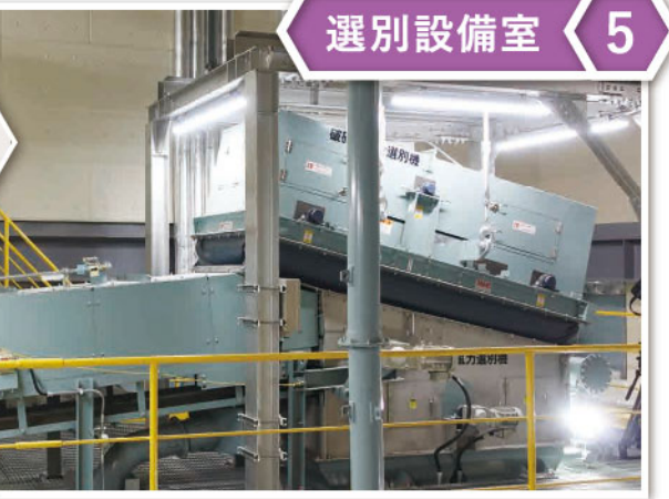
不燃ごみ・粗大ごみを細かくする高速回転破砕機
